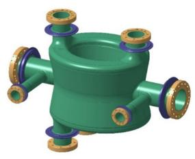
Figure 1: The DQW cavity geometry.
