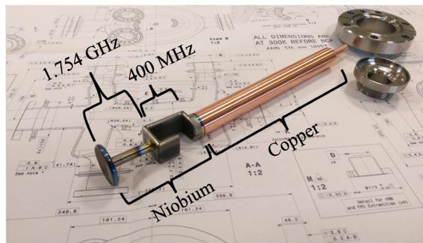
Figure 4: Parts of the DQW SPS-series pickup.
