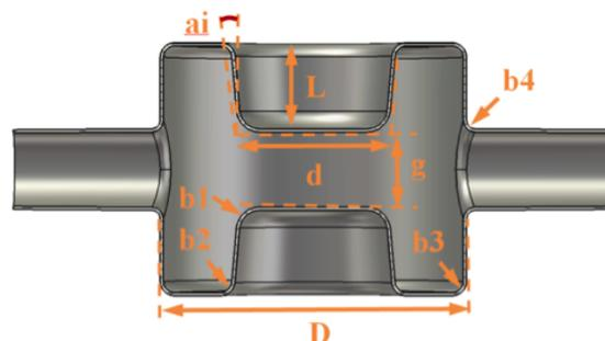
Figure 4: Geometry parameters of a basic DQW cavity.
