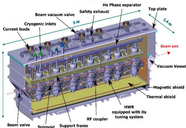
Figure 1 : SARAF phase 2 low beta cryomodule.
