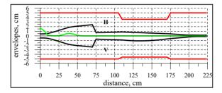
Figure 10: <sup>209</sup>Bi<sup>38+</sup> ion beam envelopes.
