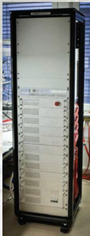
Твёрдотельный ВЧ генератор для ПЭТ циклотронов на рабочую частоту 72 МГц с выходной мощностью 10 кВт (слева)
