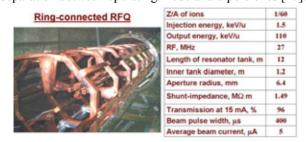
Figure 6: Prototype of heavy ion driver for inertial fusion ISBN 978-3-95450-170-0
