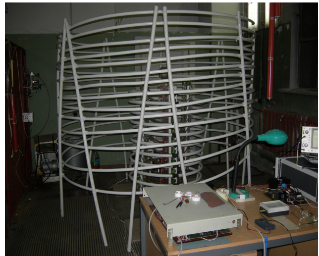
Fig.4. HV generator prototype U = 250 kV, I_i = 1 mA.
