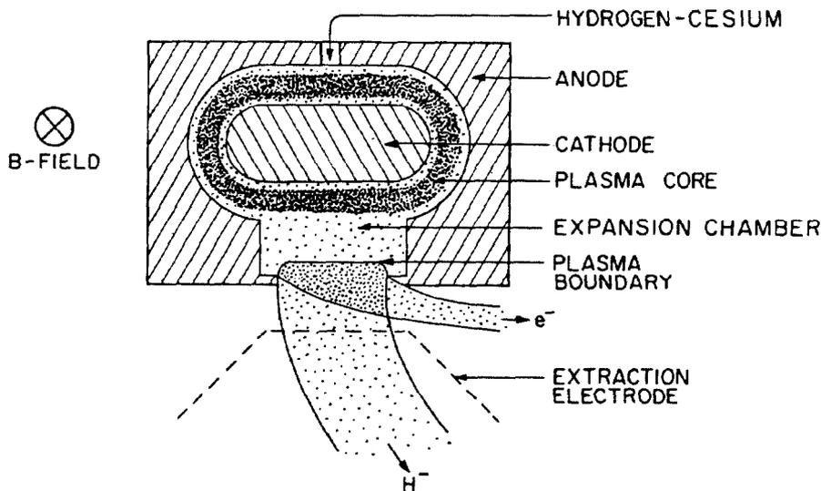
ILLUSTRATION OF NEGATIVE ION MAGNETRON
