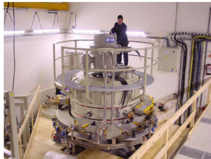
6 pass 7 MeV 700 kW Rhodotron (IBA)
