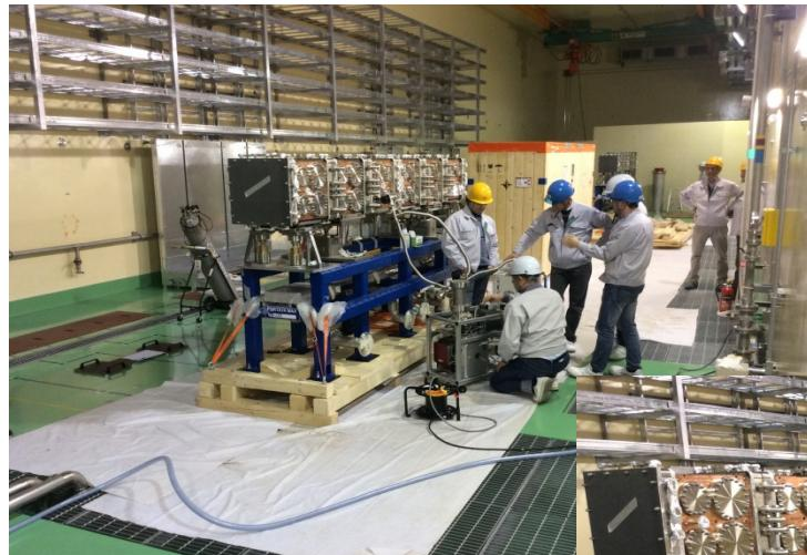
Vacuum leak  $< 2 \times 10^{-10}$  mbar-l/s per module
