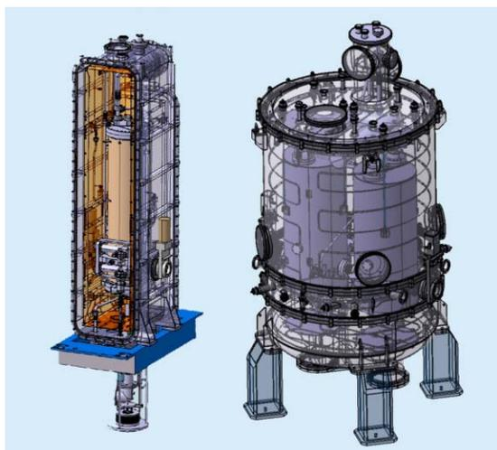
Figure 3: QWR cryomodules (left  $\beta$ : 0.07, right  $\beta$ : 0.12)
