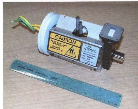
Figure 2: MG6005 magnetron.
