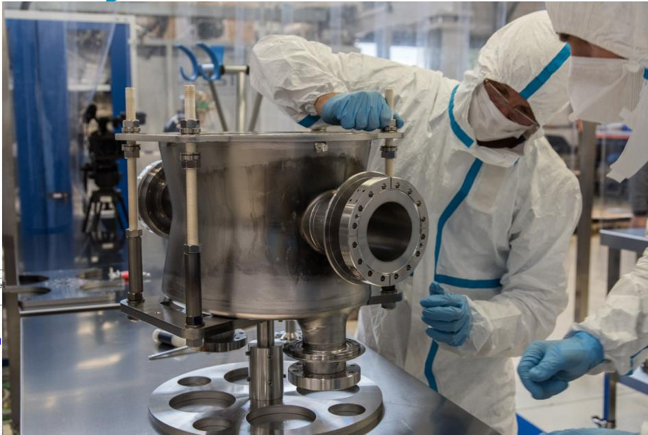
CERN DQW prototype for SPS test
