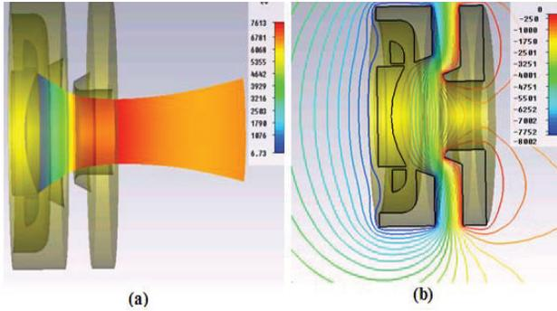
Figure 2: a) Electron trajectory, b) Equipotential lines.
