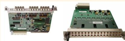
Fig. 7: MTCA.4 SIS8800 Multi Purpose Scaler und SIS8980 RTM Discriminator
