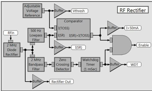
Figure 7: Rectifier Module.
