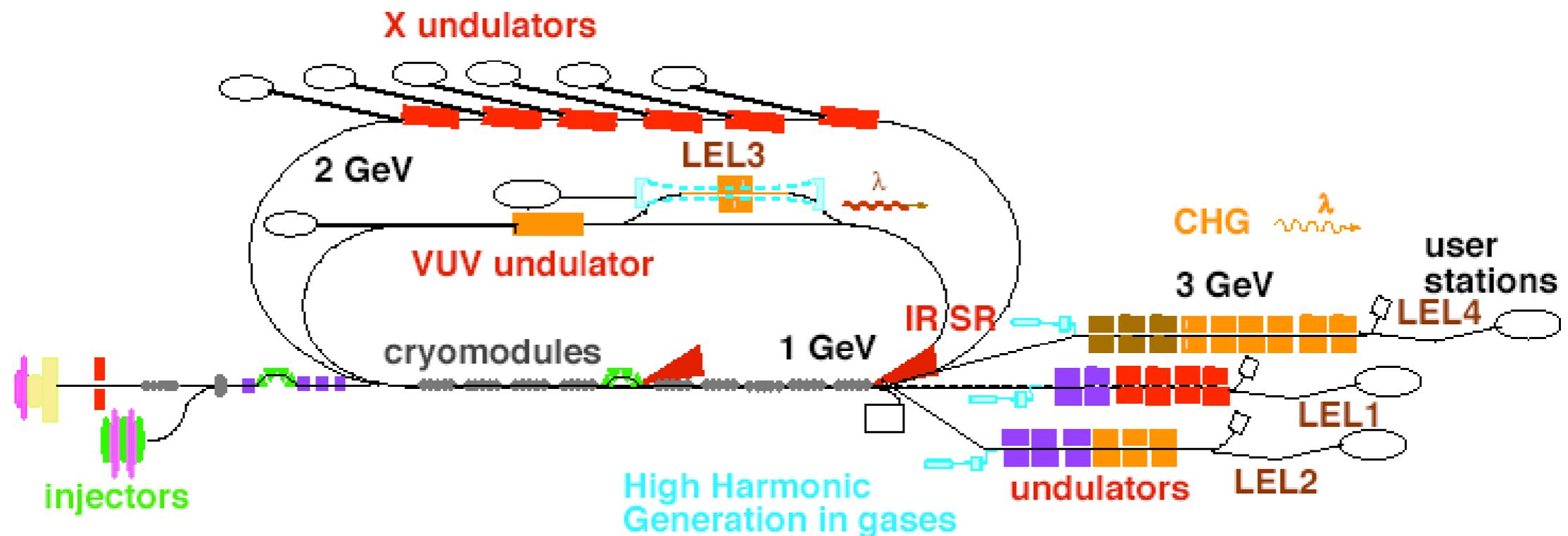
LEL4 : Modulator : U35 cryo, NI=700, Radiator : U18 cryo, N2=1000
