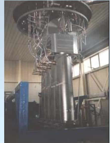
LNL 80 MHz,  $\beta=0.055$  cryostat
