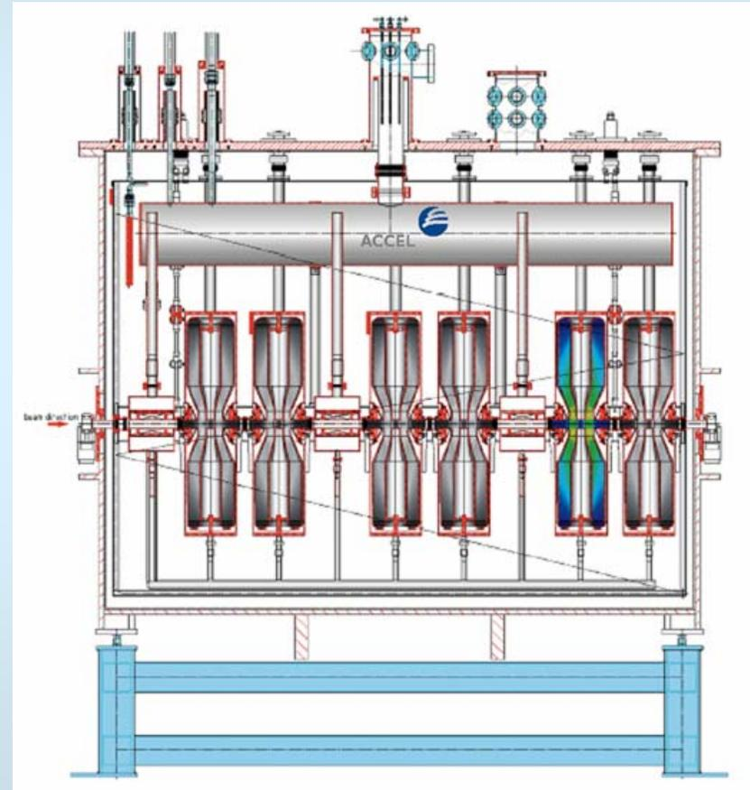
Cryomodule n.1 – p and d from 1.5 MeV/u
