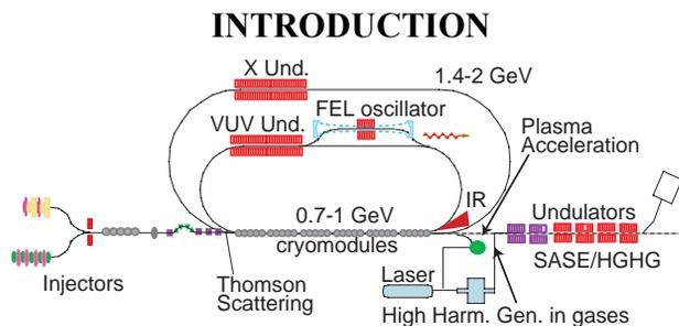
Fig. 1 : Schematic of ARC-EN-CIEL layout
