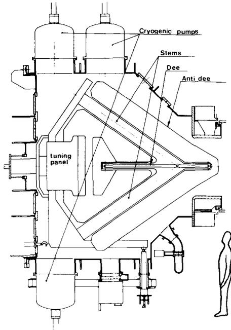
Fig. 11 : Resonator section
