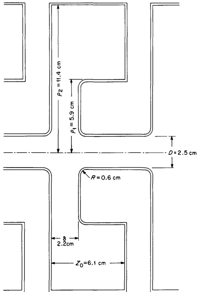
Re-Entrant Cavity For Heavy - Ion Linac 650 MHz.
