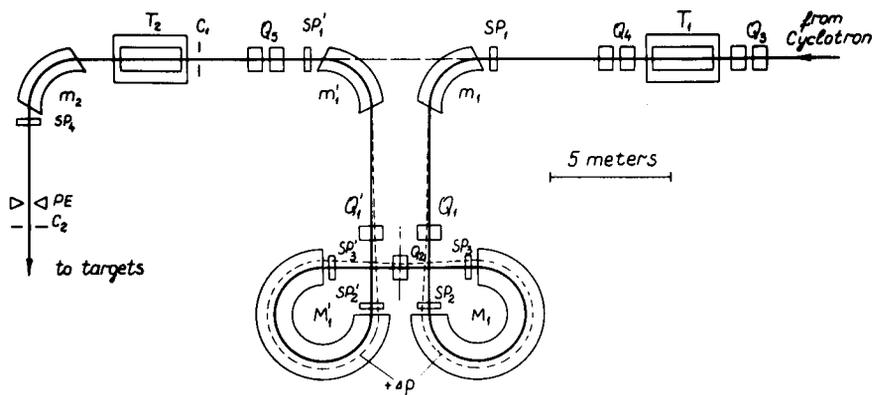
Fig. 2. Monochromatisation system
