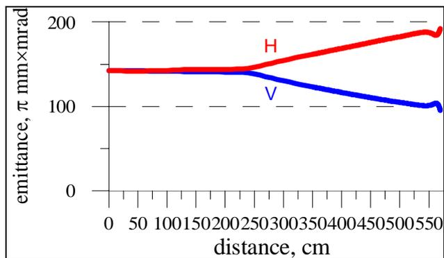
Figure 5: <sup>48</sup>Ca<sup>6+</sup> beam emittance
