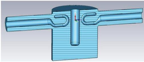
Figure 3: Final Design for the DQW FPC test box.
