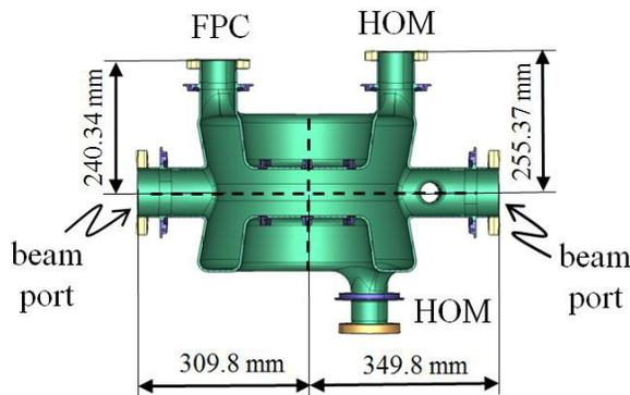
Figure 8: SPS DQW cavity with flange position.
