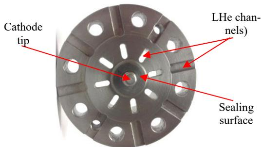
Figure 11: Nb cathode plug.
