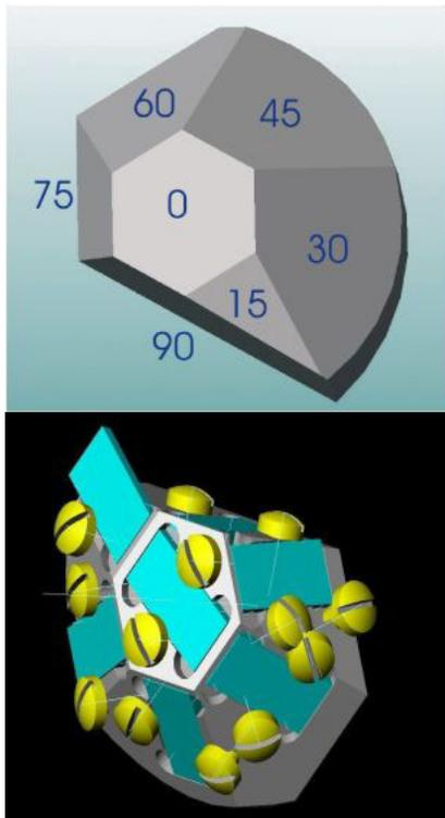
FIG. 6. Multi-angle substrate holders (faces at 0°, 15°, 30°, 45°, 60°, 75°, 90°)
