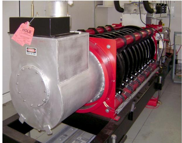
Figure 1: Klystron.
