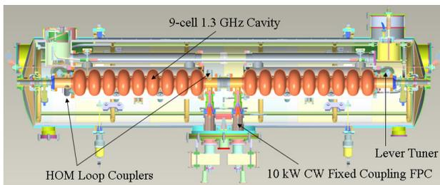
Figure 3: ALICE Cryomodule.
