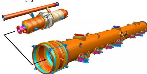
Figure 2: XFEL Cryomodule.
