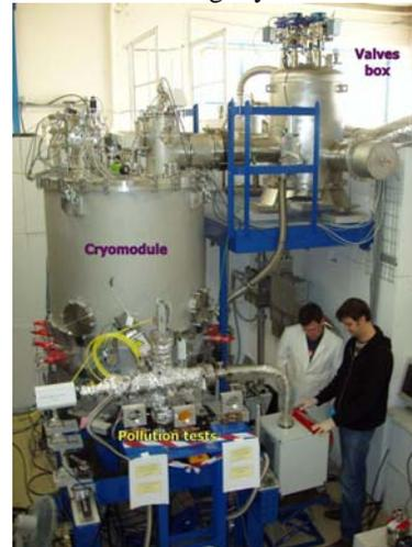
Figure 5 : qualification type B cryomodule ( $2\times\beta=0.12$ ).
