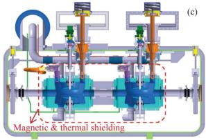
Figure 1: (a) DQWCC with 3 HOM filters, (b) HOM filter; (c) Cryomodule with two DQWCCs.
