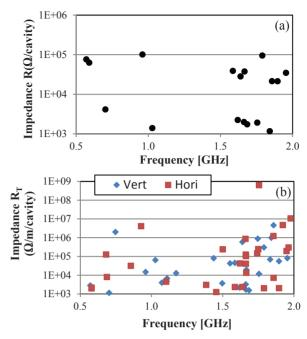
Figure 3: DQWCC shunt impedance (a) Longitudinal; (b) Transverse.
