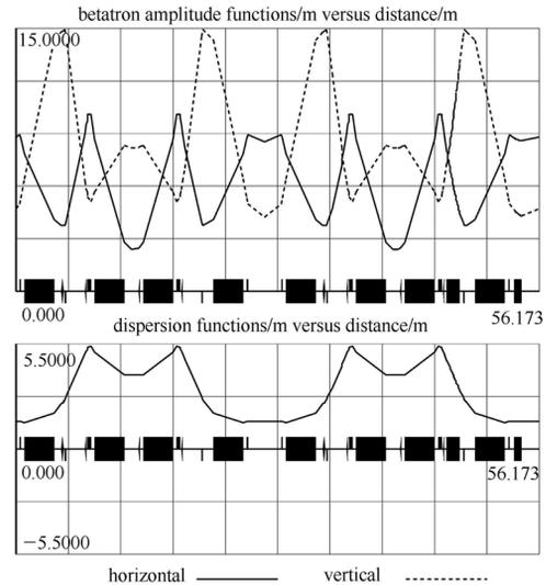
Figure 2: Twiss parameters of the synchrotron.
