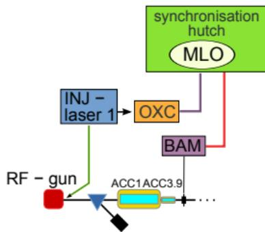
$$\delta t_{\text{bunch}} = G_{\text{gun}} \delta t_{\text{gun}} + G_{\text{laser}} \delta t_{\text{laser}}$$
