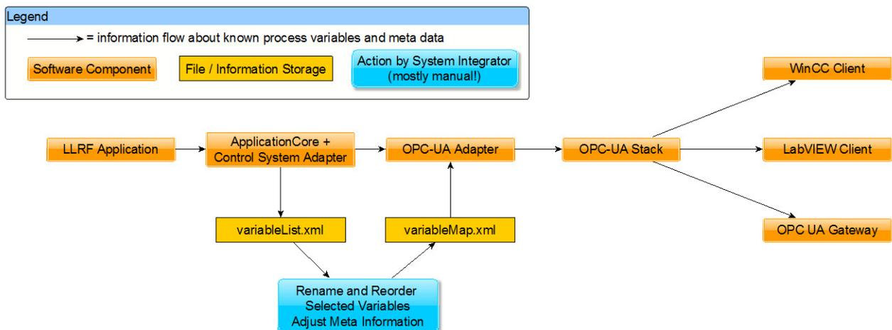
Figure 2: ChimeraTK OPC UA adapter - variable mapping scheme.
