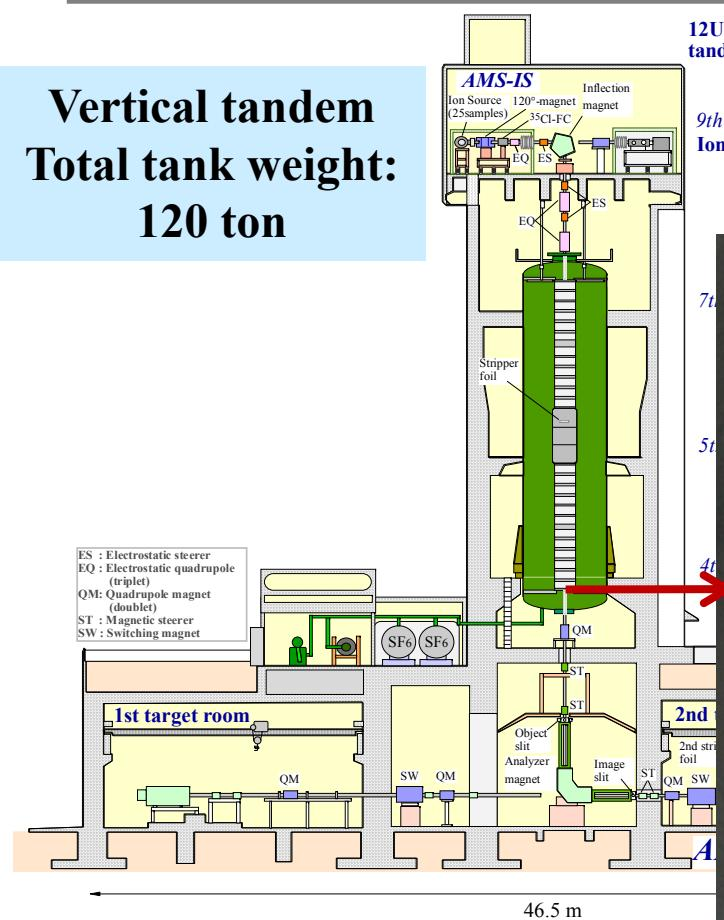
12UD Pelletron tandem accelerator
