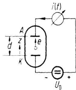
Abb. 8.1/5. Ebene Zwei-Elektrodenstrecke einer Vakuumsdiode
