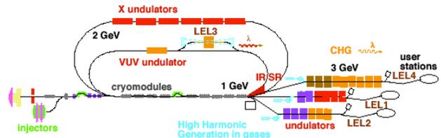
Figure 1 : General scheme of ARC-EN-CIEL.
