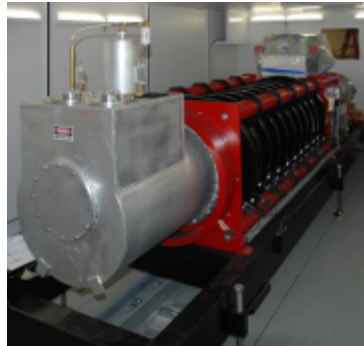
1MW CW Klystron
