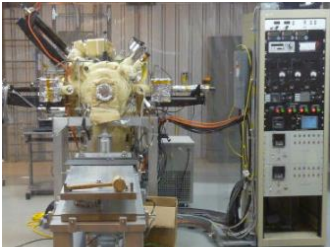
ERL Cathode deposition system at BLD912
