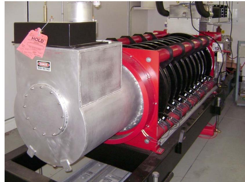
1 MW klystron
