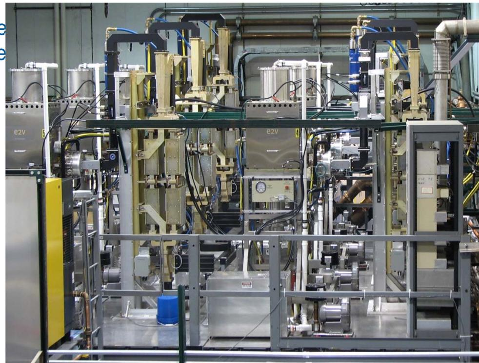
5 x 135 kW 1.3 GHz klystron transmitter
