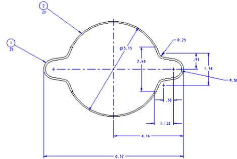
Figure 3: DQ3 and DQ5 Vacuum chambers cross section
