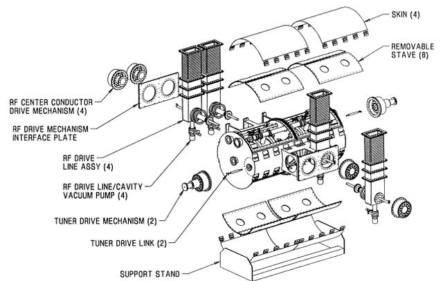
Fig. 7. Medium-cryomodule.
