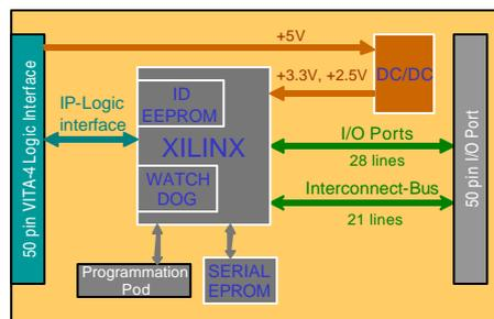
Figure 3: RPS IP-Module
