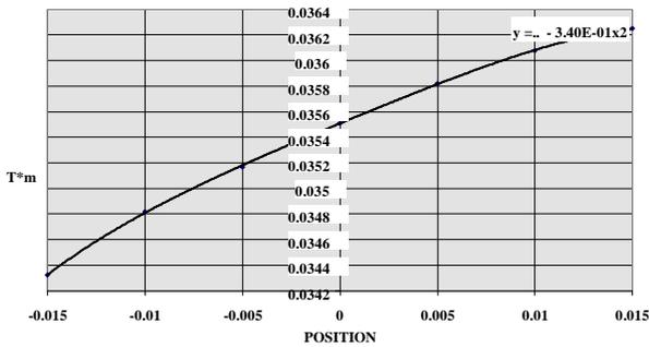
Fig. 9 INTEGRATED DIPOLE END FIELD (1.5 T)
