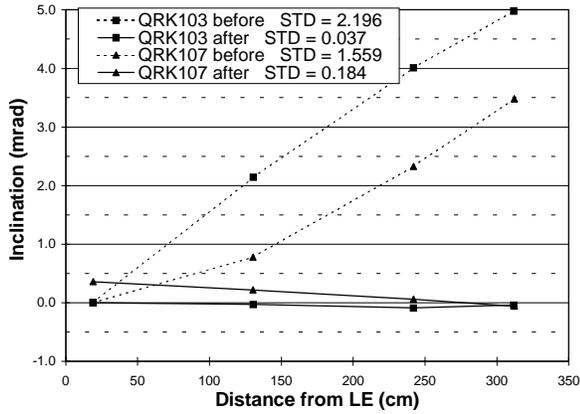
Figure 3. 13 cm Q2 Quadrupole Twist Data.
