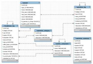
Figure 15: Database schema.
