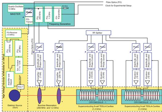
Figure 4: Block Diagram of the ELBE RF-System.
