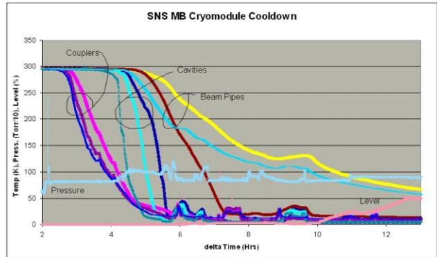
Figure 7. Cryomodule Cooldown
