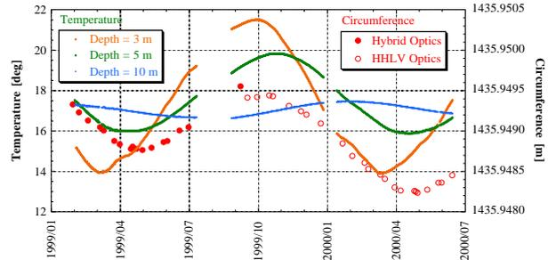
Figure 4: Change of underground temperatures from Feb. 1999 to Jun. 2000.
